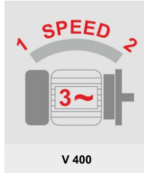
**Maschinenausführung mit einem 3x400V Antrieb mit 2 Geschwindigkeiten**
